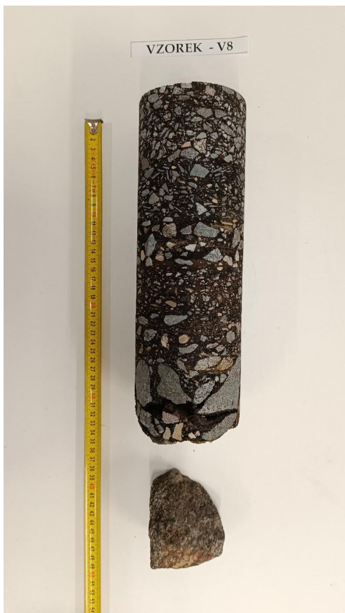
Obr. 16 - Jádro vývrtu Vzorek – V8 (laboratoř).
