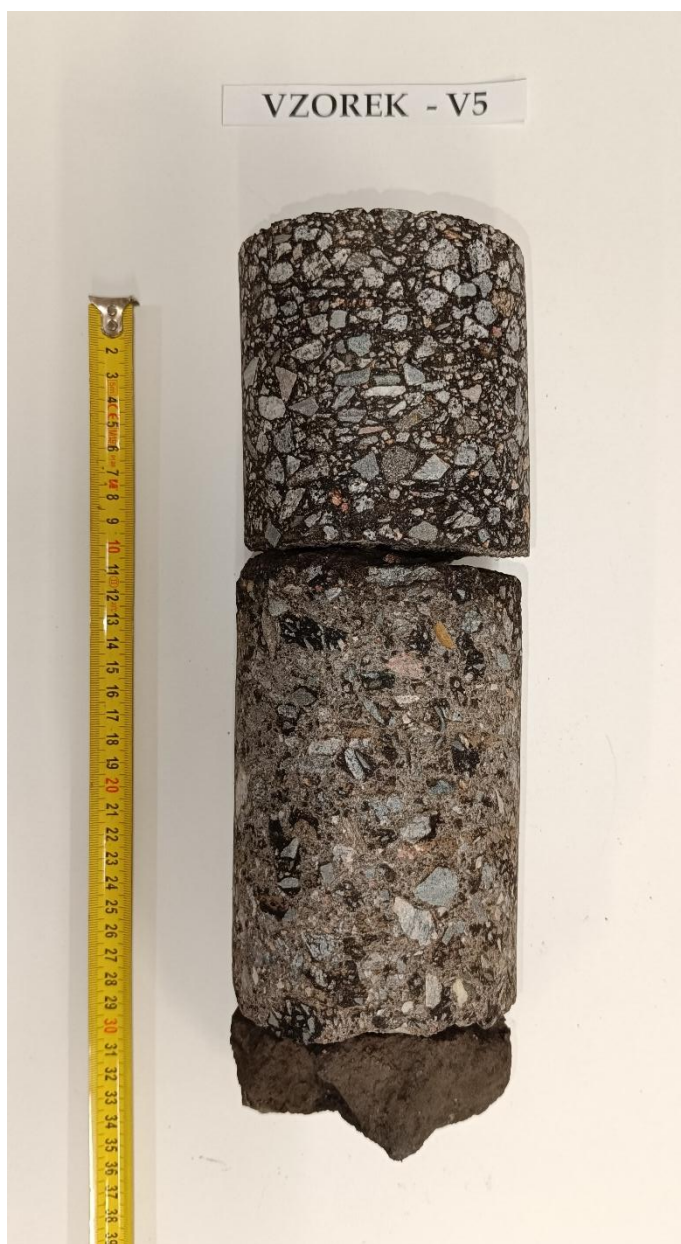
Obr. 10 - Jádro vývrtu Vzorek – V5 (laboratoř).
