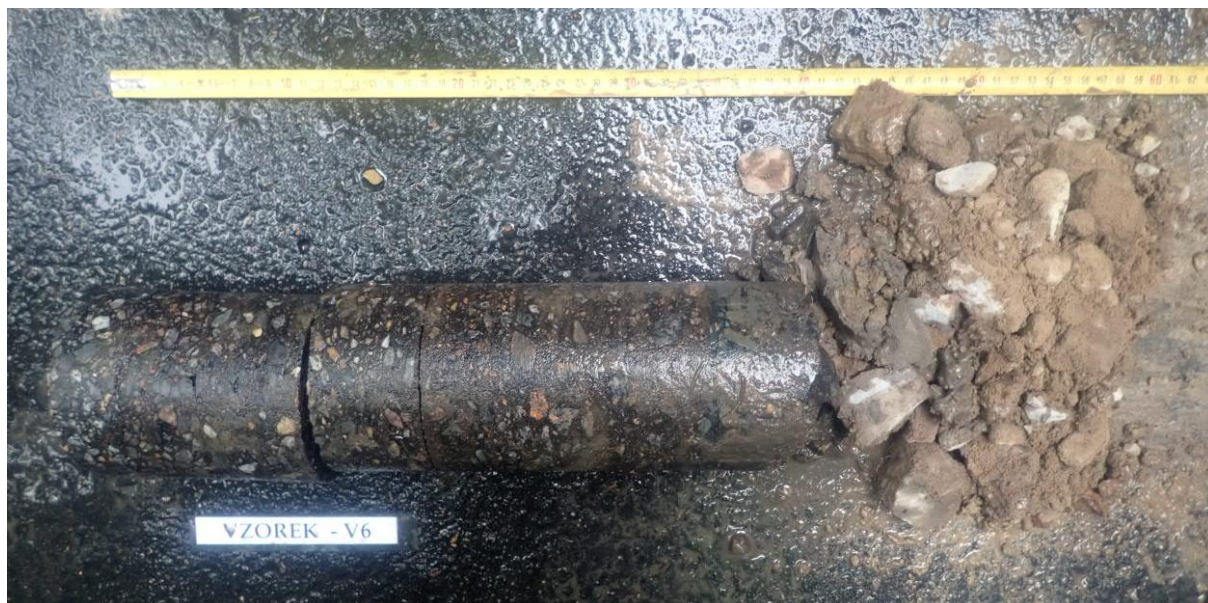
Obr. 11 - Jádro vývrtu Vzorek – V6 (in situ).
