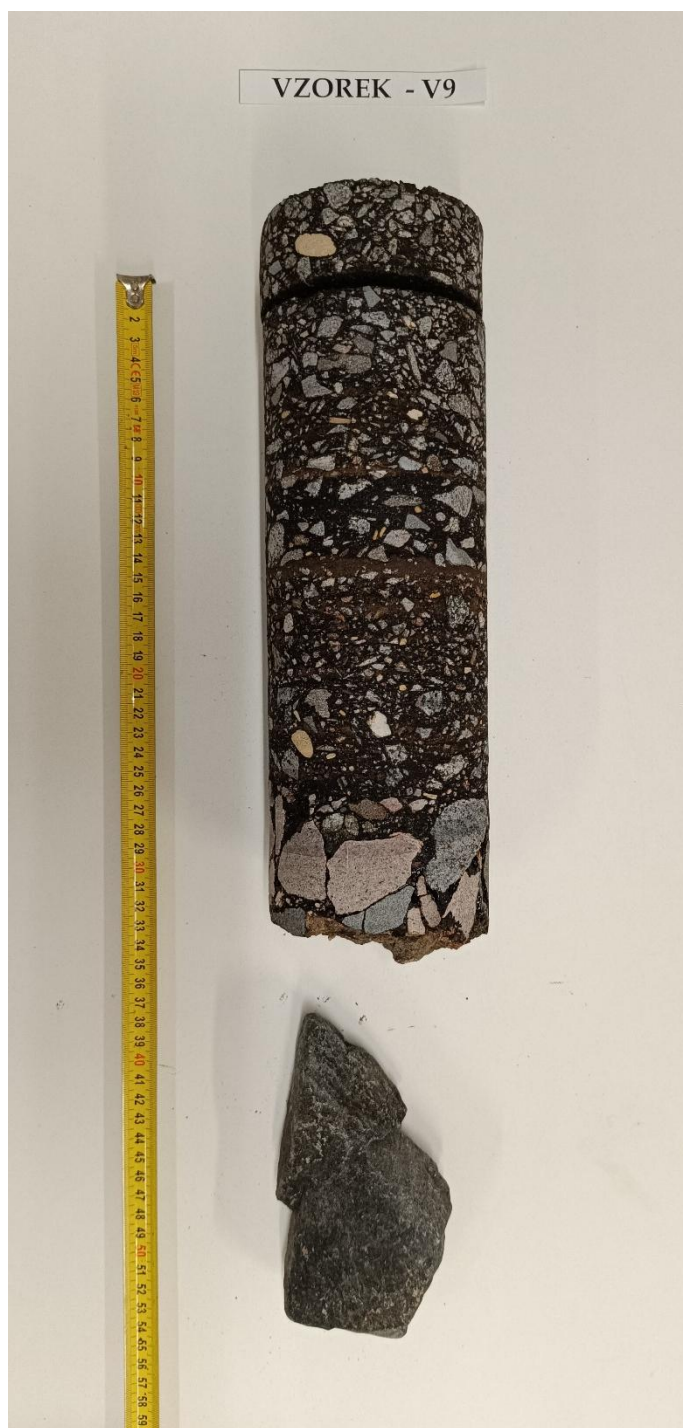
Obr. 18 - Jádru vývrtu Vzorek – V9 (laboratoř).
