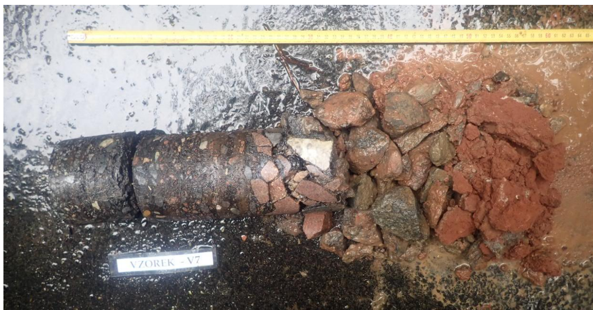
Obr. 13 - Jádro vývrtu Vzorek – V7 (in situ).
