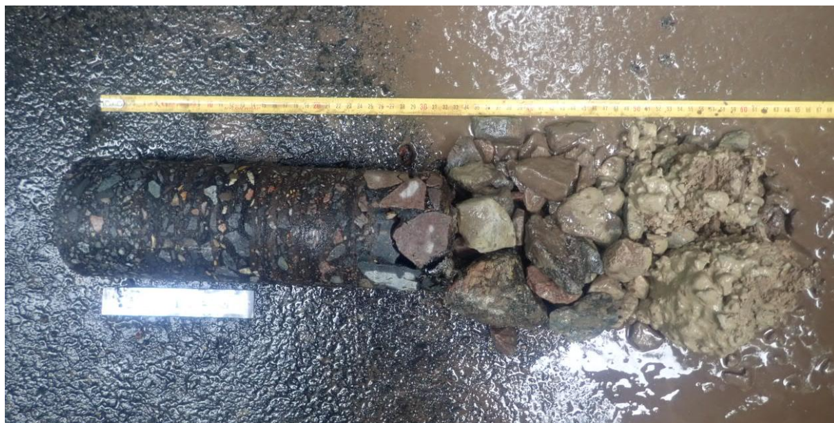
Obr. 15 - Jádru vývrtu Vzorek – V8 (in situ).
