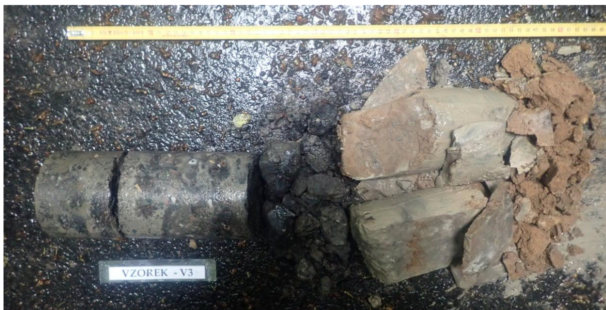
Obr. 5 - Jádro vývrtu Vzorek – V3 (in situ).
