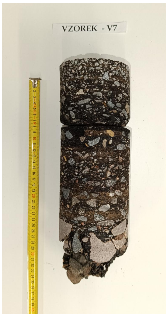
Obr. 14 - Jádro vývrtu Vzorek – V7 (laboratoř).
