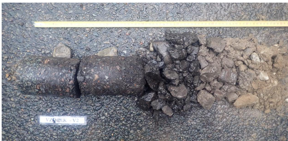
Obr. 3 - Jádro vývrtu Vzorek – V2 (in situ).
