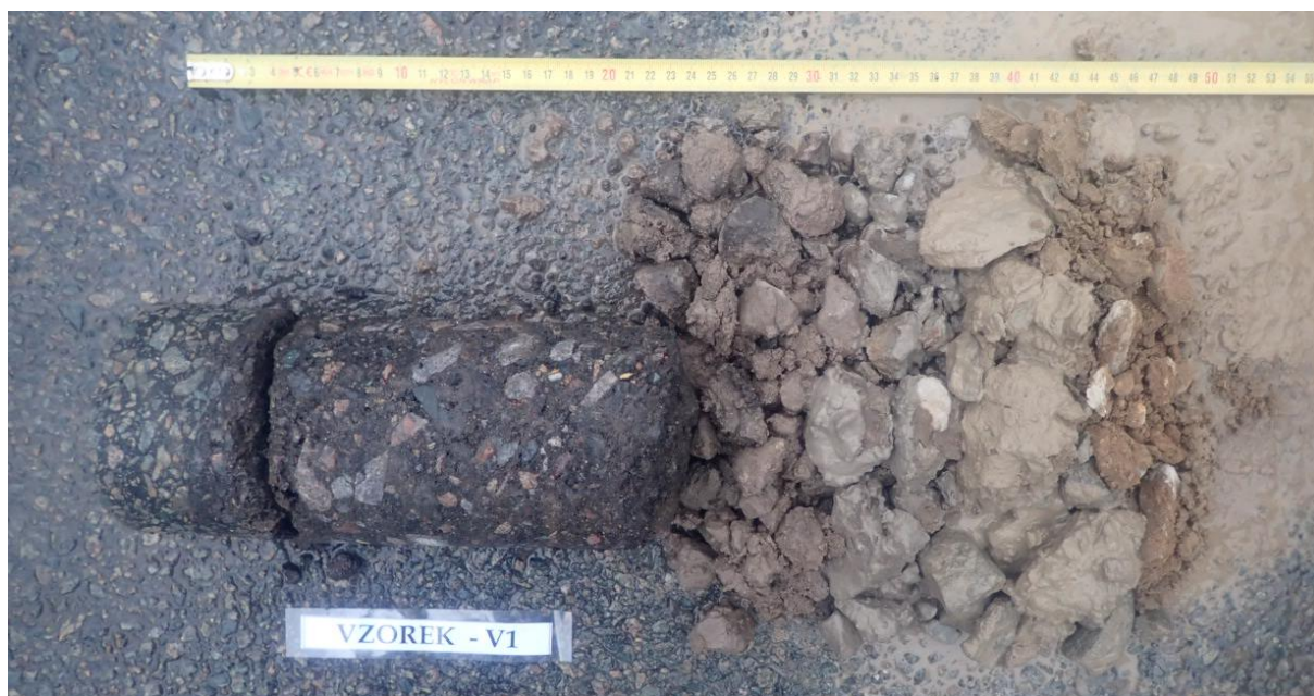
Obr. 1 - Jádro vývrtu Vzorek – V1 (in situ).
