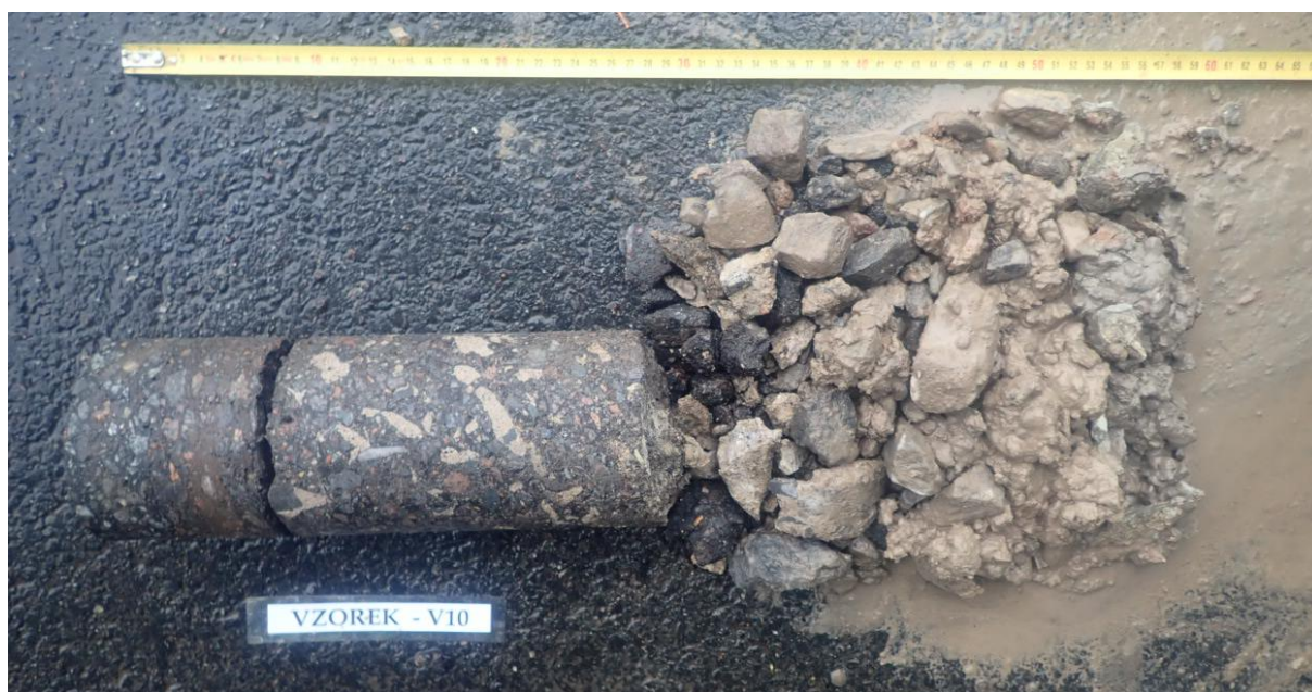
Obr. 19 - Jádro vývrtu Vzorek – V10 (in situ).
