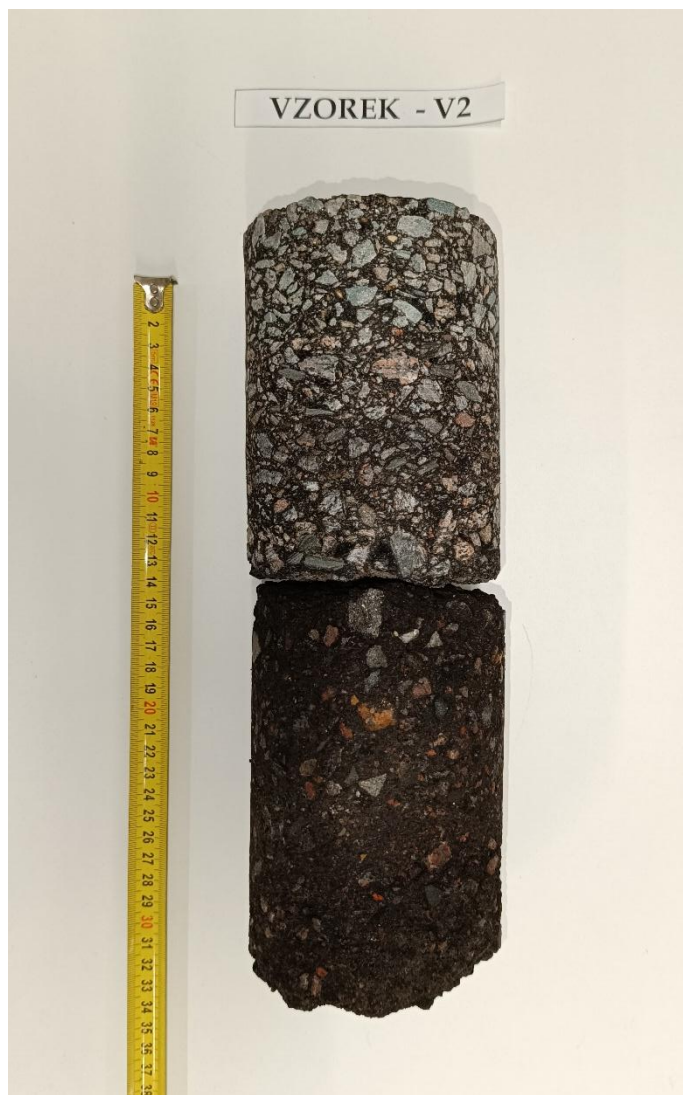
Obr. 4 - Jádro vývrtné Vzorek – V2 (laboratoř).
