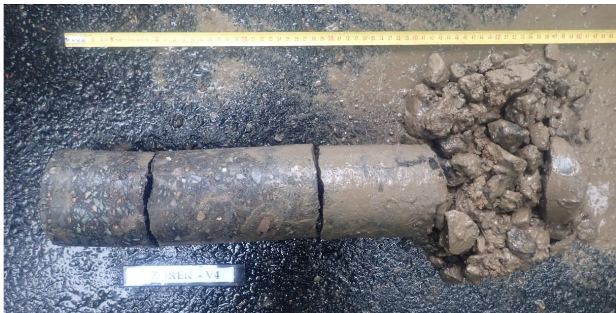
Obr. 7 - Jádro výtvetu Vzorek – V4 (in situ).
