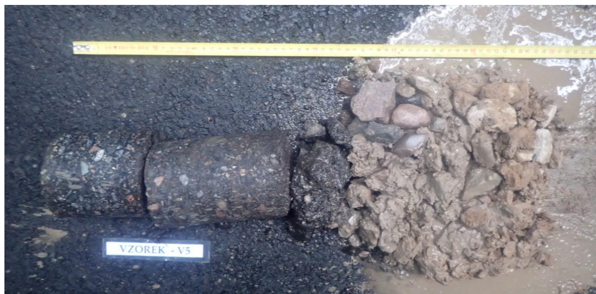
Obr. 9 - Jádro vývrtu Vzorek – V5 (in situ).
