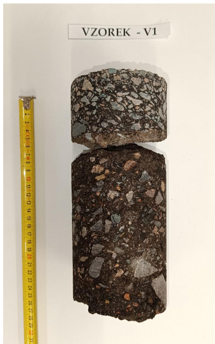
Obr. 2 - Jádru vývrtní vzorek – V1 (laborator).
